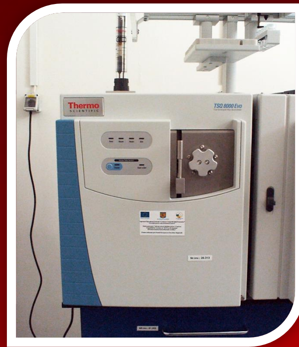
Spectrometru de masă triplu cuadrupol TSQ 8000 Evo GC-MS/MS Thermo Scientific™
