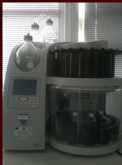
Sistem de extracție accelerată cu solvenți Thermo Scientific™ Dionex™ ASE™ 350 (unic în țară)
