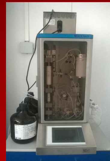
Sistem de purificare automată a extractelor LCTech DEXTech™ (unic în țară)
